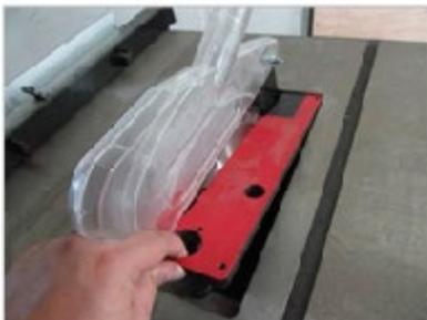
Soulevez la cape de la lame et insérez l'insert de la table. Fermez l'insert.
