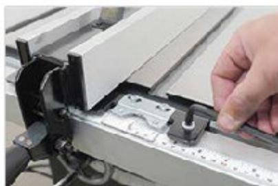
Utilisez la clé Allen fournie pour ajuster les vis de réglage avant. Avec cette clé, relevez ou abaissez les vis en nylon jusqu'à ce qu'elles entrent en contact avec le profil avant du guide.
