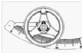
Le réglage de la hauteur de l'arbre permet de régler la hauteur de coupe. La molette de commande est équipée d'un verrouillage du réglage de la hauteur. Derrière la molette de commande se trouve une règle. Pour un déplacement vers le haut, tourner dans le sens des aiguilles d'une montre, pour un déplacement vers le bas, tourner dans le sens inverse des aiguilles d'une montre.
