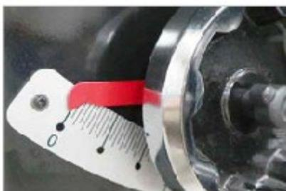
Réglez l'inclinaison de la lame sur 0 degré et bloquez la molette pour que celle-ci ne bouge pas pendant le retrait ou la mise en place de la lame.
