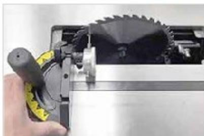
**AVERTISSEMENT : ASSUREZ-VOUS QUE LA SCIE N'EST PAS BRANCHÉE.** Retirez l'ensemble des accessoires et l'insert de la table, placez la lame à la position la plus haute et perpendiculaire à la table. Prenez la première mesure, à environ un centimètre des dents de la lame, comme illustré.
