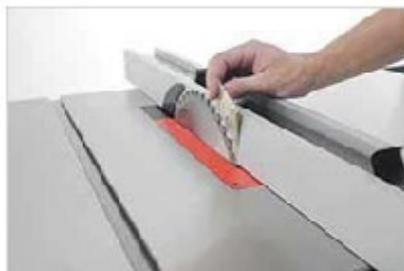
AVERTISSEMENT : ASSUREZ-VOUS QUE LA SCIE N'EST PAS BRANCHÉE. Déployez la lame et approchez le guide de celle-ci, sans qu'il la touche. Pour garantir une distance suffisante, insérez un morceau de papier plié entre la lame et le guide.
