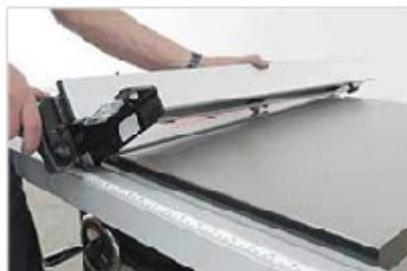
Tout en tenant le guide et le levier de verrouillage, soulevez le levier pour ouvrir le dispositif de verrouillage. Insérez le guide dans le système de guidage.
