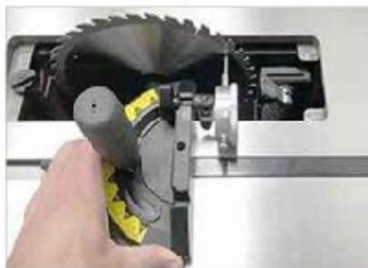
Faites glisser lentement le guide dans la rainure. Effectuez une deuxième mesure et comparez avec la première mesure. Ajustez la table si nécessaire. Desserrez les 3 vis avant de procéder au réglage, voir l'étape 4.
