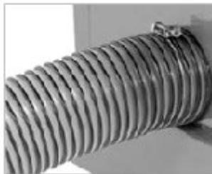
Une sortie d'aspiration se trouve au bas de la scie et est prévue pour être raccordée à un aspirateur de copeaux (non inclus). Le débit d'air maximum est de 20 m/s. Si le débit d'aspiration n'est pas inférieur à 20 m/s, (selon la norme EN 12779:2004+A1:2009), prévoyez un autre système d'extraction approprié. L'opérateur(rice) de la machine doit porter un masque anti-poussière.
