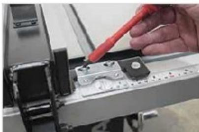
Desserrez les vis de la loupe à l'aide d'un tournevis cruciforme (ne retirez pas la loupe). Ajustez la loupe et serrez les vis.
