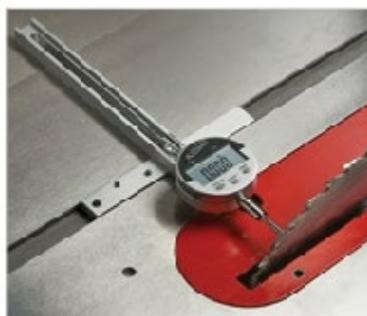
Comparateur spécial avec possibilité de fixation dans la rainure.
