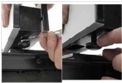
Mise en parallèle du guide longitudinal avec la lame :
