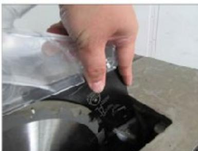
Insérez avec précaution le couteau diviseur dans l'orifice et poussez. Assurez-vous que le couteau diviseur est bien enfoncé dans l'orifice et qu'il est entièrement inséré dans le mécanisme de serrage. Saisissez le couteau diviseur et gardez votre autre main libre pour le verrouillage.
