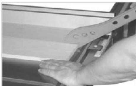
Couper le bois dans le sens de la longueur pour en réduire la largeur est qualifié de coupe longitudinale. Pour couper dans le sens de la longueur, tenez la pièce à deux mains et poussez à la fois la pièce et le guide pour obtenir une coupe droite.
