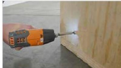
Utilisez une perceuse ou un tournevis cruciforme pour dévisser les vis du fond de la caisse. Ces vis peuvent être mises au rebut.
